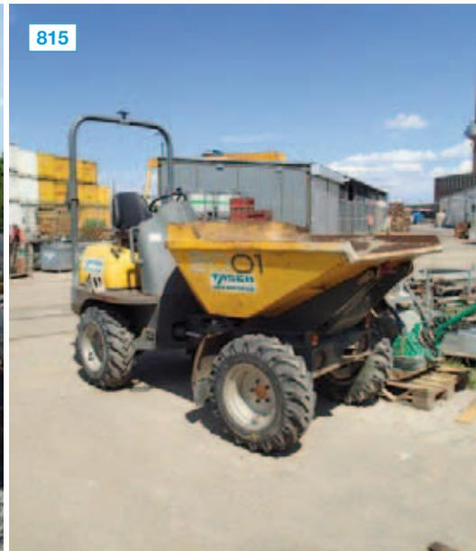
1 Dumper, Fabr. Lifton Neuson, Typ 2001, Bj. 2003, Ser.-Nr. GA000145, zul. GG 3.890 kg, Leistung 21.9 kW
