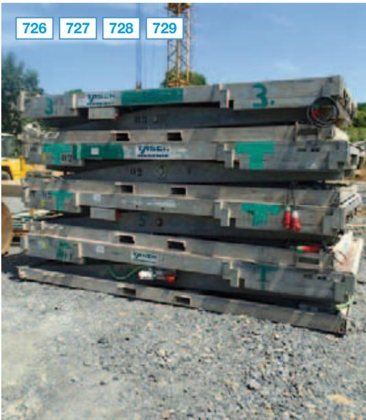
1 Scherenhubbühne, Fabr. Steinherr, Typ SB3, max. Tragfähigkeit 3.000 kg
