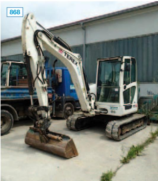
1 Midiraupenbagger, Fabr. Terex, Typ TC50, Bj. 2006, Ser.-Nr. TC00500107, zul. GG 5.000 kg, Leistung 29 kW, Planierschild, Monoblockausleger, Löffelstielhydraulik, Grabenräumschaufel
