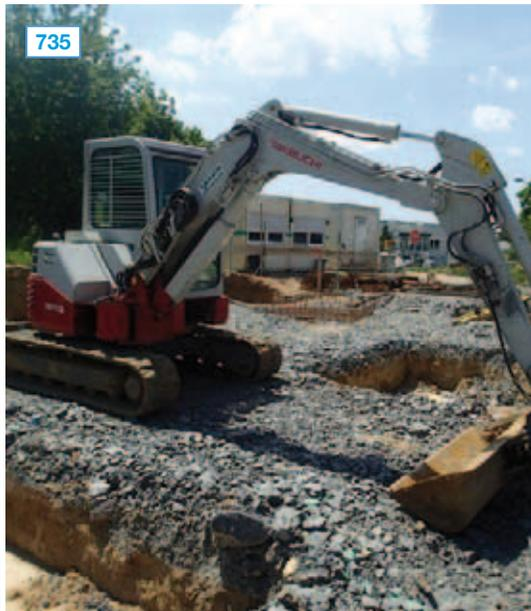
1 Minibagger, Fabr. Takeuchi, Typ TW135FR, Bj. 2011, Ser.-Nr. 156301087, Leistung 29,6 kW, Planierschild, Monoblockausleger, Löffelstielhydraulik, Grabenräumschaufel
