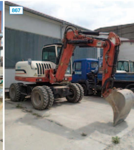
1 Hydraulikmobilbagger, Fabr. Schaeff, Typ HML32, Bj. 2003, Ser.-Nr. 3200/0335, zul. GG 9.500 kg, Leistung 95 kW, Planierschild, Verstellausleger, Tieflöffel
